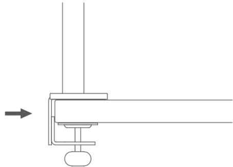
**Pour installer le support à travers un œillet.**
