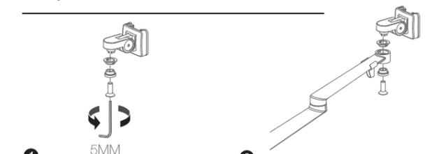
**1** Retirez les vis de l'adaptateur avec la clé hexagonale.
